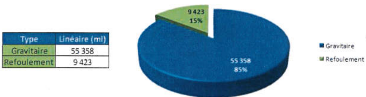
Figure 13 : Répartition des linéaires par type de réseaux
